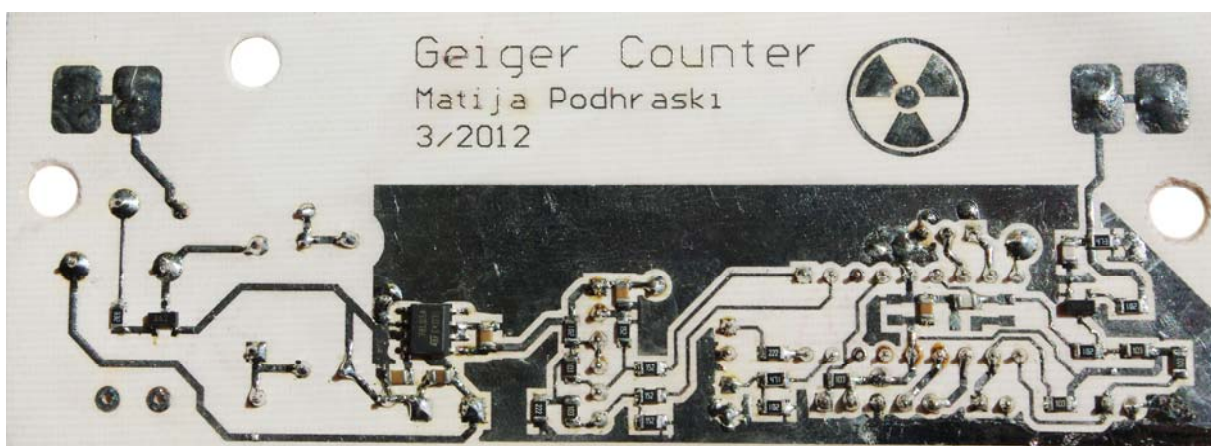
Slika 3: spodnja stran pospajkanega in sestavljenega tiskanega vezja
